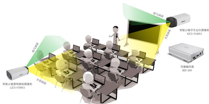
解决方案包含拍摄教师的**智能云镜教师机**、拍摄学生的**智能云镜学生机**、采集整个教室音频的**阵列互动音频处理器**和吊麦、录制教师电脑屏幕的**导播编码器**，以及应用于系统通信、管理、切换和导播的软件系统模块。设备之间通过一根POE网线实现互联互通、智能跟踪拍摄、自动导播及切换。
